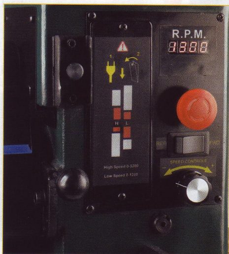
Alles auf einen Blick: Ein/Aus-Schalter, Drehzahlregelung, Drehrichtungsumschalter und digitale Drehzahlanzeige
